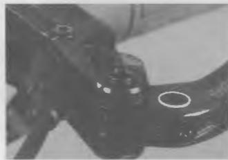
Hebellagerbolzen mit dem Werkzeug wieder einpressen. ACHTUNG! Auf die Position des Bremshebels achten.
