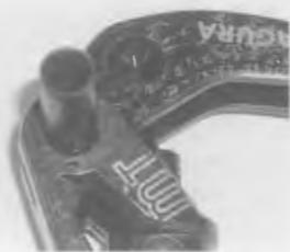
Hebellagerbolzen einsetzen, dann Hebel einführen, hier auf die Position der Feder und Griffweiteneinstellschraube achten.
