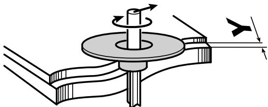
$$Y = 1/2 (\text{Ø de la bague de copiage} - \text{Ø de la fraise})$$
