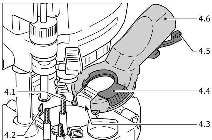
Les copeaux peuvent être évacués par le capot d'aspiration. Le plastique transparent permet une bonne visibilité sur l'outil. Le manchon d'aspiration (4.6) permet de raccorder un aspirateur Festool doté d'un flexible de 36 mm ou 27 mm. Pour limiter les risques de bourrage, nous recommandons un diamètre de 36 mm.
