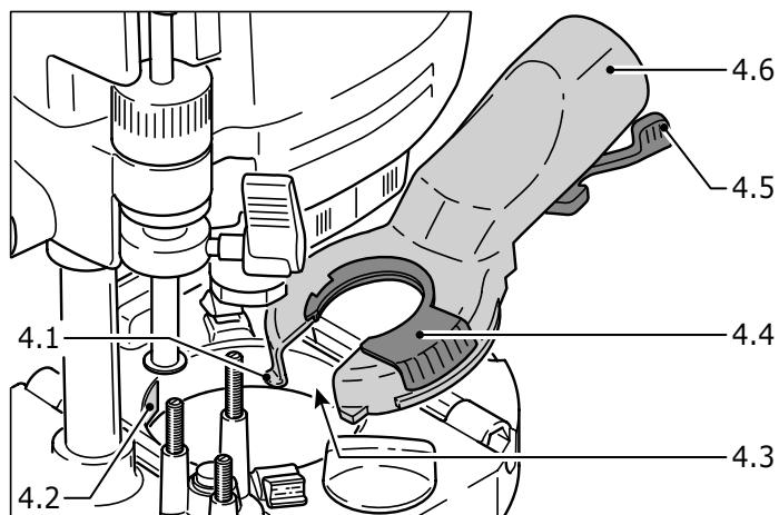
Las virutas producidas al fresar se pueden aspirar mediante la caperuza de aspiración. El plástico transparente posibilita una vista libre a la herramienta para fresar. Se puede conectar un aparato de aspiración Festool en los racores de aspiración (4.6) con un diámetro de tubo de 36 mm o 27 mm. Debido al reducido peligro de obstrucción recomendamos 36 mm.
