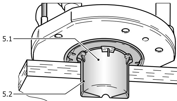
Mediante el colector de virutas KSF-OF (5.1) (parcialmente en el suministro) se puede aumentar la efectividad de la aspiración al fresar cantos.
