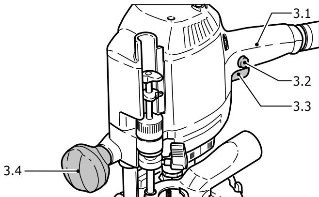
**ADVERTENCIA** La máquina tiene que ser sujetada siempre con ambas manos por las empuñaduras (3.1, 3.4) durante la conexión y el uso.
